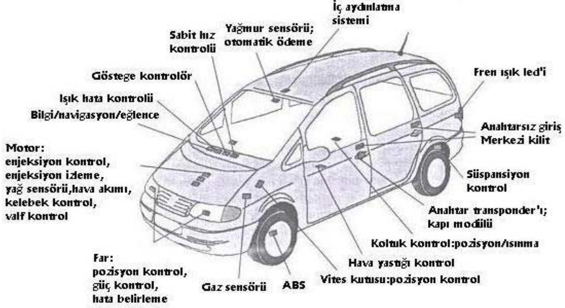
Şekil 2. Araç üzerindeki sensör ve kontrol birimleri
